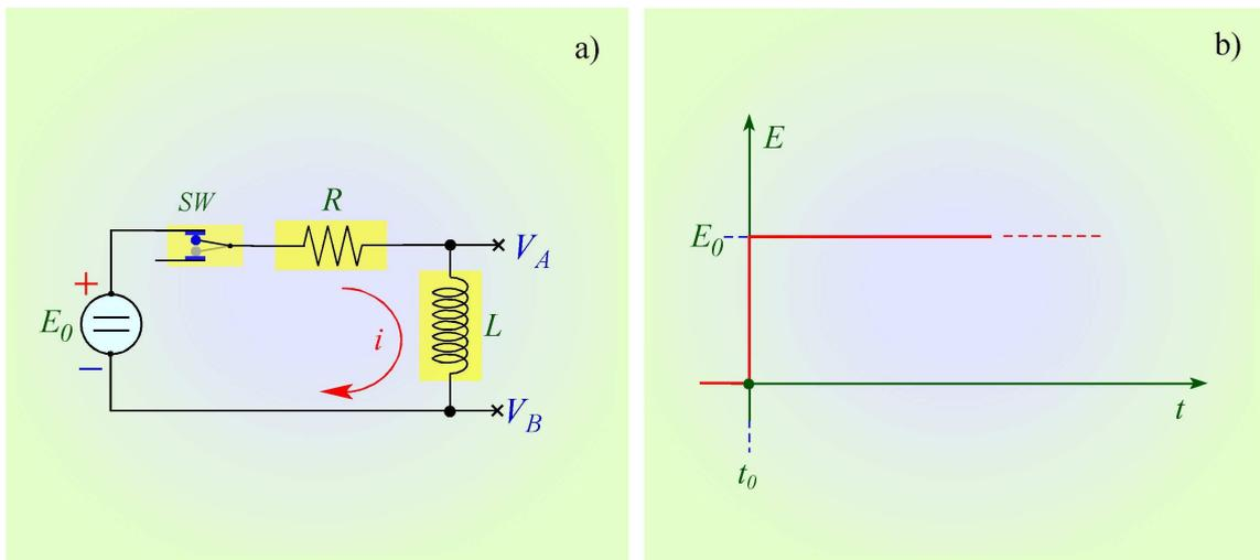
Fig.1.5.4) a) - Un circuito *RL* serie connesso ad un generatore di corrente continua tramite il deviatore *SW*.
