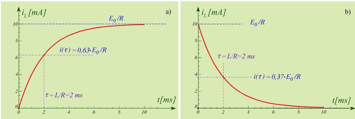
Fig.1.5.5) La funzione  $i_L(t)$  per un circuito RL in cui  $R=100\Omega$ ,  $L=200mH$ , con  $E_0=1$  volt.
